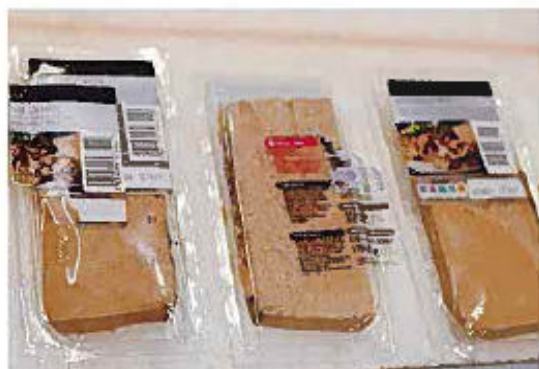
Exemples de défauts : des étiquettes mal positionnées, double étiquetage...
