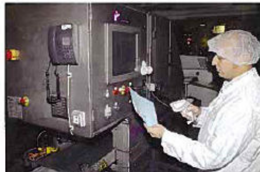
Au démarrage de chaque série de production, les étiquettes carton (encaissage) et produits sont scannés.
