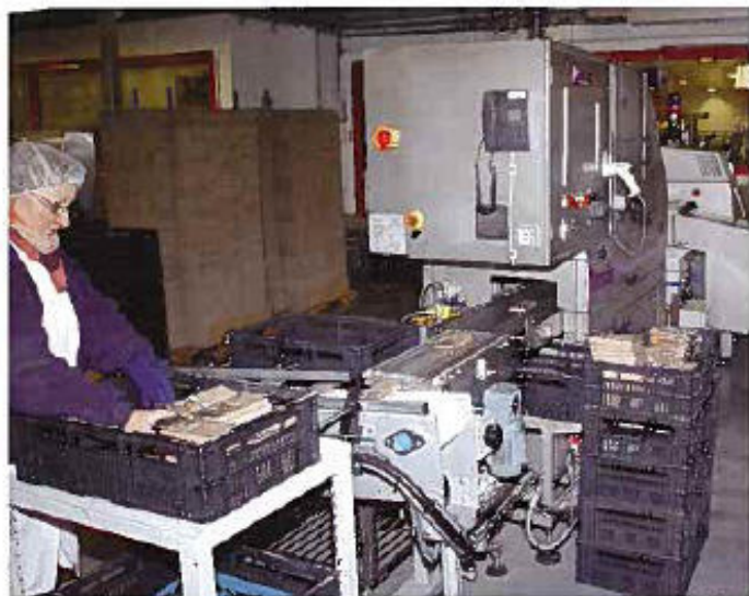
La ThermoSecure modèle L300 qui permet la vérification à 100 % de la conformité de la barquette : soudure correcte et étiquetage conforme
